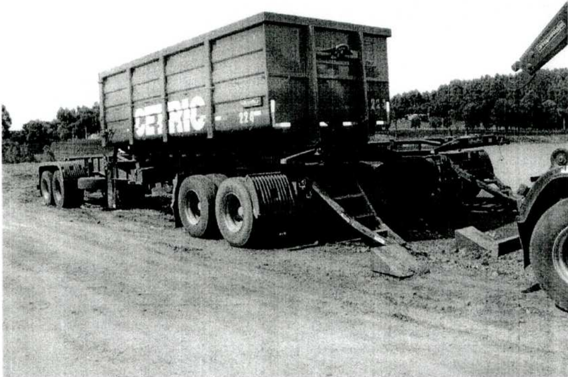
Figura 08 – Contêiner para armazenamento de 25 m 3 .
